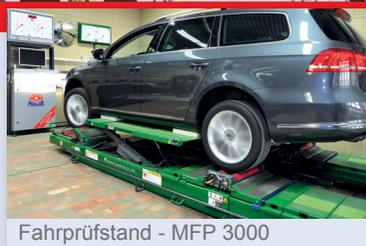
Fahrprüfstand - MFP 3000
