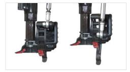
Integrierter Demontagefinger macht das Montiereisen überflüssig.
